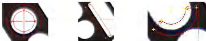
17、全局扫描功能可快速得到异形产品轮廓转换成 CAD 格式，实现快速抄数、工程逆向。
